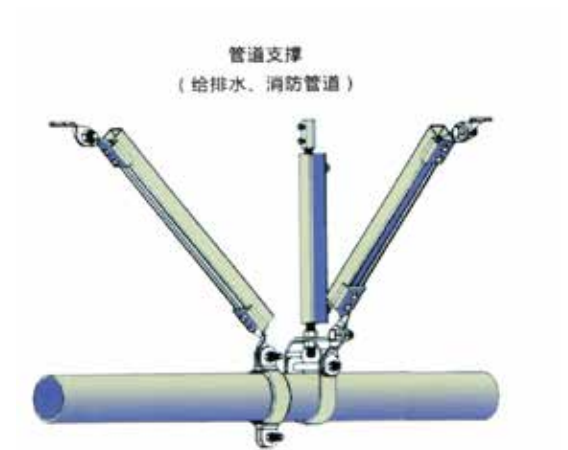
图1 一种给水系统及消防管道支撑装置
