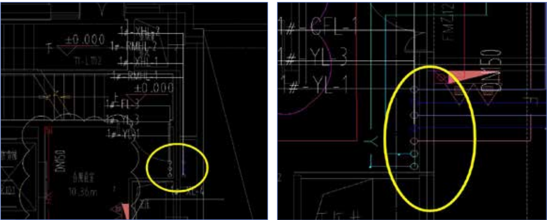
图1 给排水上下楼层立管位置不一致
