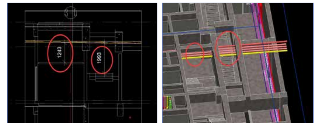
图9 重力水管阻挡楼梯休息平台
