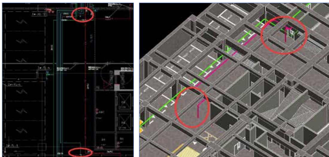
图7 给排水喷淋立管阻挡汽车行车道
