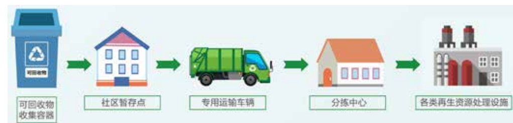
图1 可回收物分类运输流程示意图
