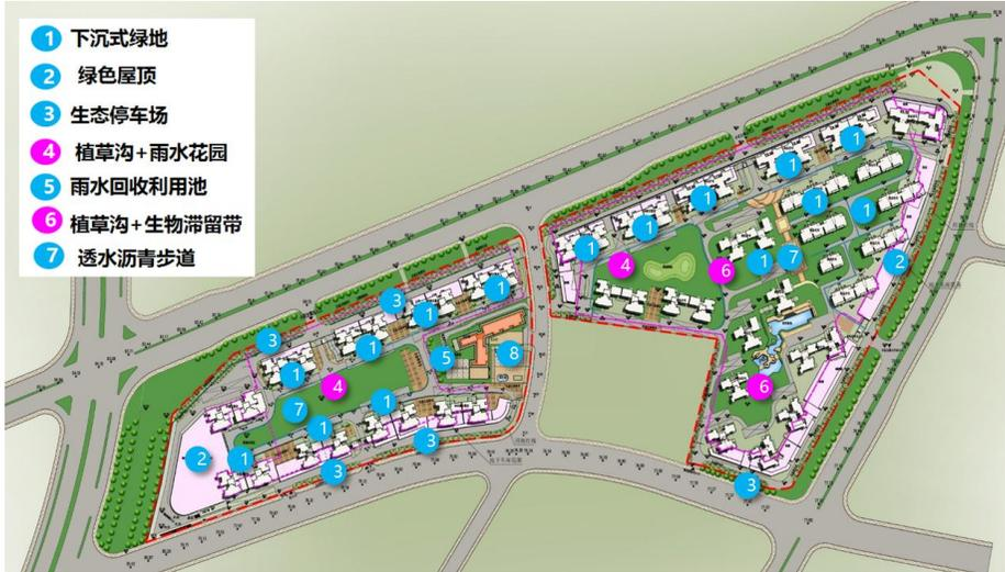
方案二（彩色花园式海绵方案）海绵化流程及海绵设施布置如下图所示：
